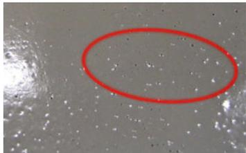
Нанесение смеси на влажный или недостаточно очищенный бетон.
